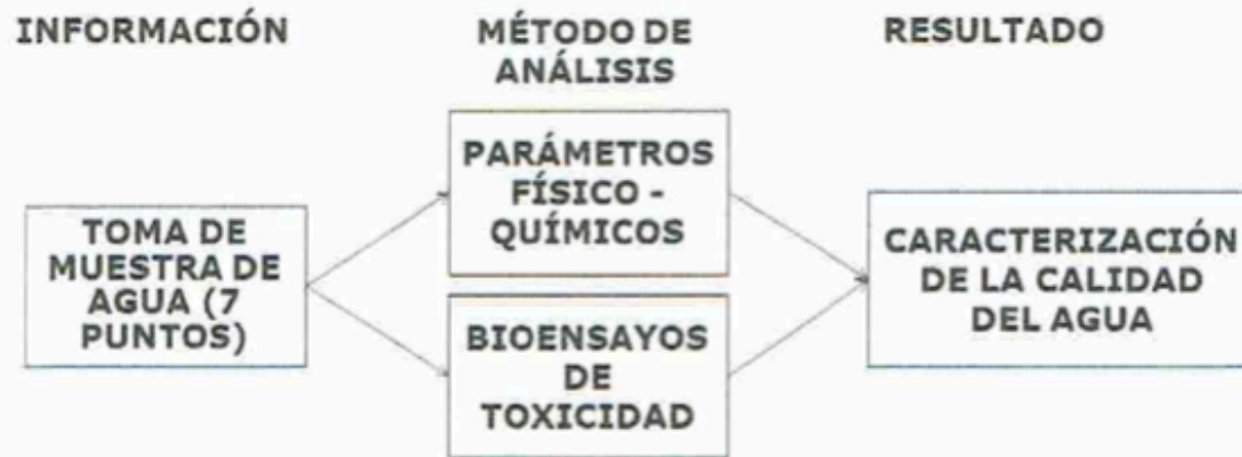
Figura 3.1. Esquema resumen aplicado para la caracterización de las muestras de agua.
